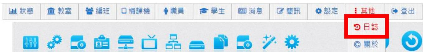
日志单元记录了所有 MTS 运作的各种事件，方便您确认系统运作时发生了什么事。当有问题发生时，本公司的系统工程师可能会询问您日志内容。
